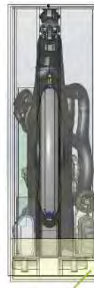
機台與包裝寬度間隙：5mm
