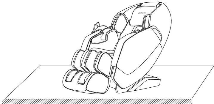
注意：在坑洼不平地面上及空間較小的地方請勿使用滑輪移動本機，如要移動，必須要兩人以上合作抬動，在抬動時以小腿擋封板及靠背蓋凹槽處為著力點(請勿直接抬動扶手)。
