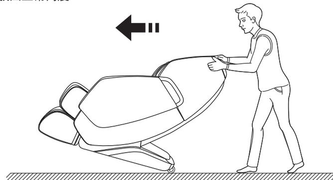
注意：在移動時務必先關閉電源開關再拔掉電源線及手控器連接線。
