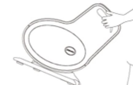
步驟三：底座後方滾輪可以接觸地面後，便可以拖曳方式，將FM220移動至適當位置後，輕輕使底座前方重新接觸地面。(圖示)
